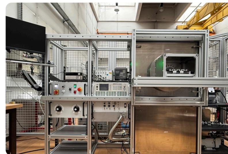
Banc de mesure de décharges partielles (DPs) pour câbles sous contrainte aéronautique
