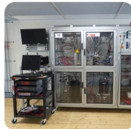
Banc de test pour piles à combustible PEM-BT fabriqué et utilisé par le LAPLACE.
