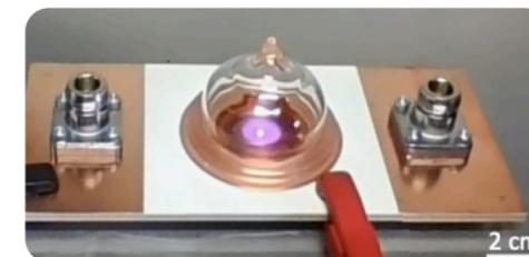
Photographie du dispositif planaire de protection plasma contre les agressions électromagnétiques. Il est constitué d'un assemblage de 3 substrats ROGERS RO4003C et d'une capsule en verre enfermant un gaz d'Argon à 10 Torr. La puissance microonde à 3 GHz injectée par un des connecteurs est transmise via une ligne micro-ruban au connecteur de sortie. Une puissance incidente élevée entraîne la génération d'un plasma qui absorbe et réfléchit l'onde incidente protégeant ainsi la sortie.
