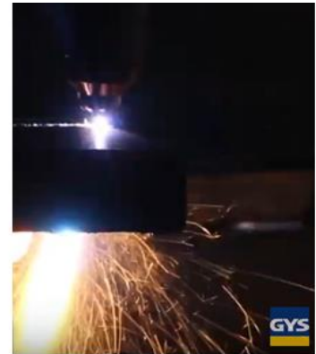
Figure 1 : Plasma créé par une torche manuelle de découpe GYS
