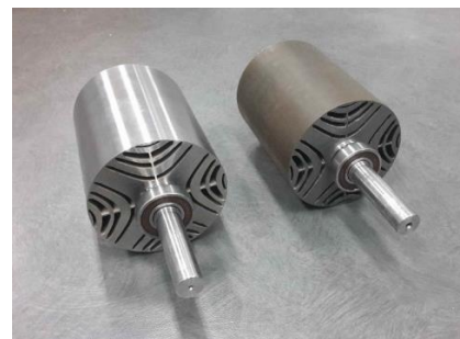
Figure 2 : Rotor en cours d'impression (à gauche) et résultat comparé à un rotor conçu avec les méthodes de fabrication usuelles (à droite).
