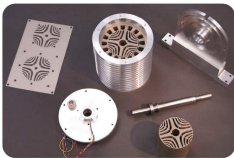
Figure 3 : Rotor optimisé et stator de la machine à réluctance variable à caractériser (à gauche) et banc de test (à droite).
