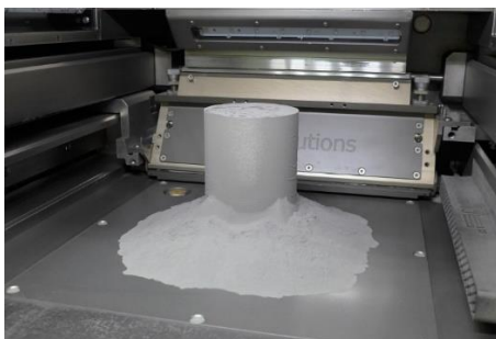
Figure 2 : Rotor en cours d'impression (à gauche) et résultat comparé à un rotor conçu avec les méthodes de fabrication usuelles (à droite).
