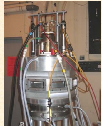
Configuration d'arc libre défecté par champ magnétique
