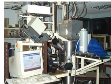
Dispositif de mesure de luminescence stimulée par différentes sources d'excitation in-situ : champ électrique, UV, température, plasma.
