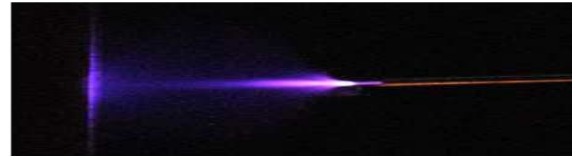
Décharge couronne de surface générée dans l'air ambiant pour la décontamination des surfaces
