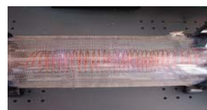
Lampe KrCl 2 pour le traitement des eaux
